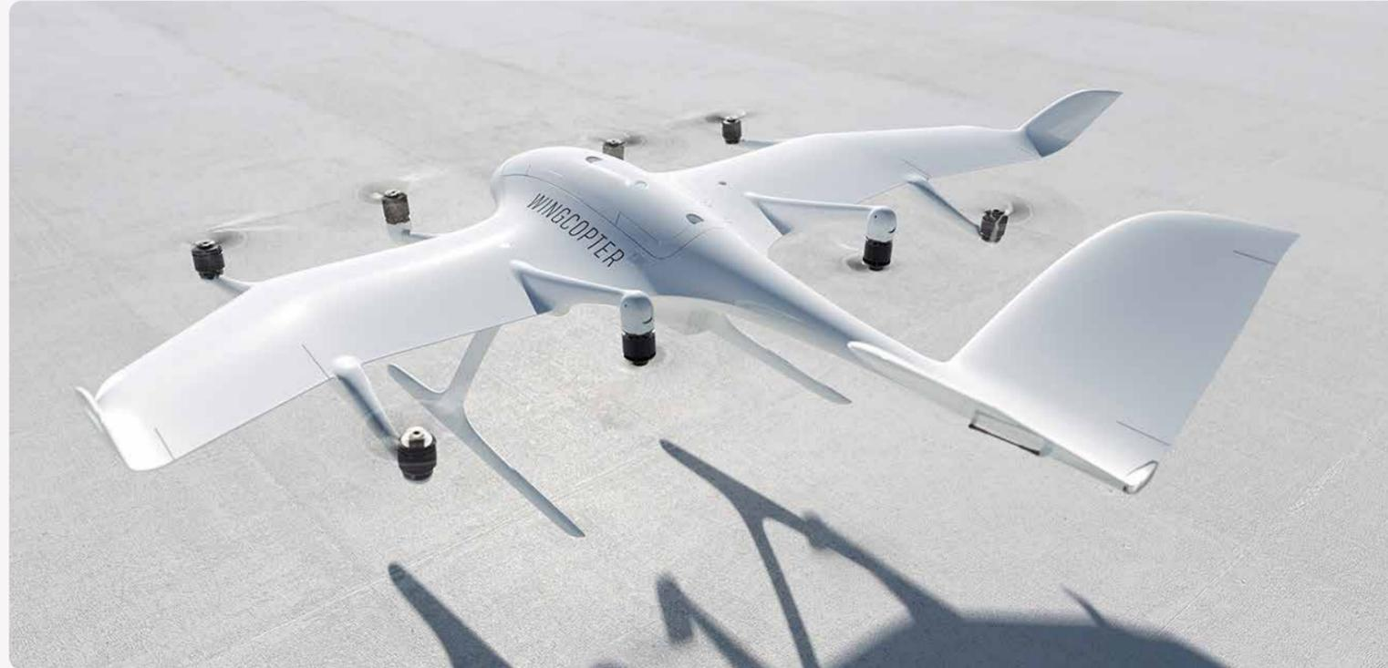
senkrechte Start- und Landemanöver durchführen und fliegt gleichzeitig lange Strecken so effizient und schnell wie eine Starrflügler-Drohne, auch bei Regen und starkem Wind.
